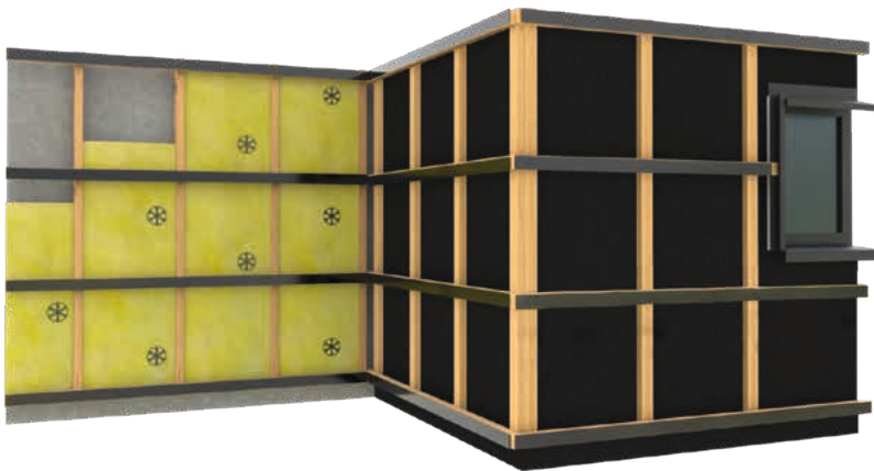
Konstruktion ohne Fassadenbahn
