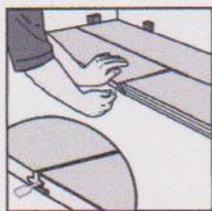
15. Falls eine Diele ausgetauscht werden muss, entfernen Sie zuerst die erste Diele ganz rechts im Raum und benutzen Sie entsprechendes Spezialwerkzeug, um die Plastikfeder von dieser Diele zu lösen.
