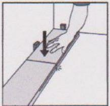
6. Legen Sie die nächste Diele an und drücken Sie sie an der Stirnseite runter, bis die Plastikfeder der Stirnseite in die Vorgängerdiele eingerastet ist. Wiederholen Sie den Vorgang, um die erste Reihe zu komplettieren.
