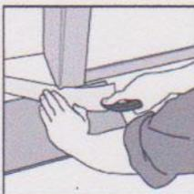
3. Legen Sie eine lose Diele umgedreht gegen eine Türzarge, um die Höhe auszumessen. Schneiden Sie das Ende der Türzarge entsprechend ab und Sie bekommen die benötigte Dehnungsfuge.
