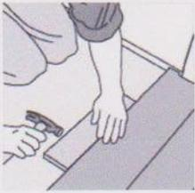
11. Alle Dielen müssen gut zusammen passen. Sollten Spalten entstehen, schließen Sie diese, indem Sie leicht mit Schlagklotz und Hammer an die Diele schlagen. Schlagen Sie niemals direkt mit dem Hammer auf oder gegen die Dielen.
