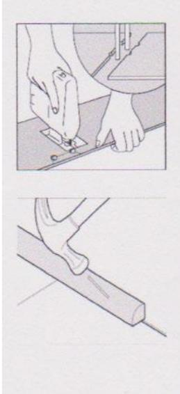
17. Messen Sie bei Heizungs- oder Wasserrohre die Position und den Durchmesser aus. Entsprechende Aussparungen auf der Diele müssen ca. 10 mm breiter als gemessen ausfallen. Schneiden Sie die Diele wie im Bild gezeigt ein und legen Sie die Diele in Position. Geben Sie Kleber auf die losen Stellen und rücken Sie die Dielen zurecht.
