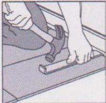
12. Benutzen Sie Hammer und Zugeisen, um Spalten zu schließen, die an angrenzenden Wänden oder Türzargen entstehen.
