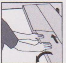
10. Die nun folgende Diele wird wie unter Punkt 9 beschrieben verlegt, aber drücken Sie diese dann runter bis die Plastikfeder an der kurzen Seite der Diele eingerastet ist und die beiden Dielen halten. Verlegen Sie die nächsten Dielen wie in den oberen Punkten beschrieben.
