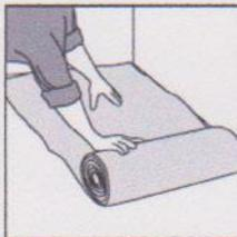
2. Unterleger können zur Trittschalldämpfung ausgelegt werden oder um leichte Ungleichmäßigkeiten im Unterboden auszugleichen. Lassen Sie die Unterleger nicht überlappen!
